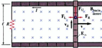
**Figura 28.20** Cuando una carga positiva se mueve a lo largo de la varilla que se está moviendo, fuerzas eléctricas y magnéticas actúan sobre ésta. La fuerza electromagnética neta sobre la carga es dirigida hacia arriba en la dirección de la velocidad de arrastre. El trabajo por unidad de carga realizado sobre la carga que atraviesa la varilla es la fem de movimiento.
