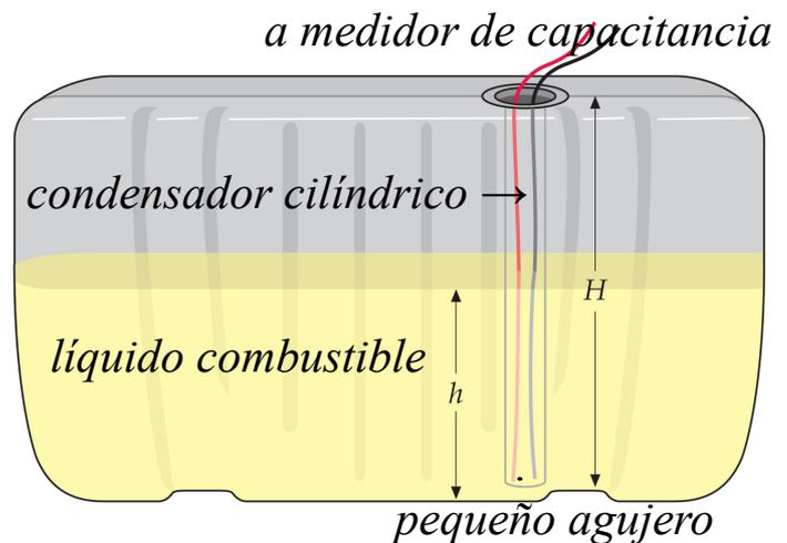
Dar un diseño en el cual la capacitancia medida nos proporcione información sobre la altura  $h$  del combustible.
